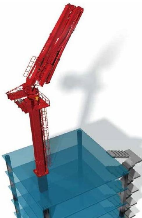
En installant dans le puits d'ascenseur, l'ouverture supplémentaire dans le plancher n'est plus nécessaire.
